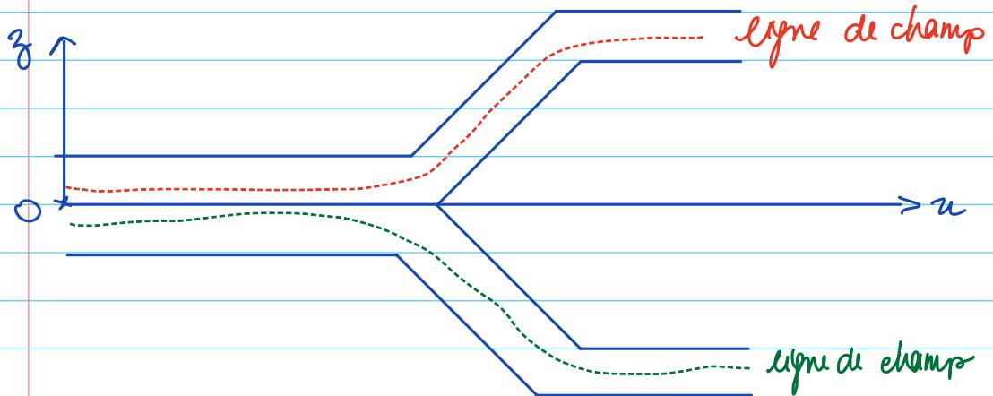
④ La conservation du débit donne  $v_0 S_0 = v_1 S_1 + v_2 S_2$
